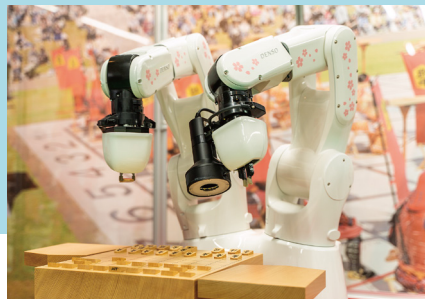
電王手桜将の展示ブース。2本のアームの連携により駒を裏返すなどの繊細な動作を実現。
